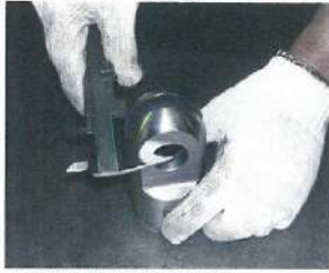
パイプエンドクレビスの寸法を測定
